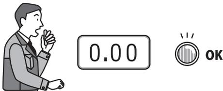
④ 次に、点検用スプレーを口腔内に2回噴射した後、2秒以内に測定を開始してください。
