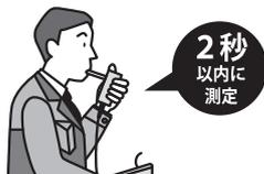
⑤ 吹き込み完了直後に「カチッ」という小さな機械音が鳴り、15秒後に0.050～0.300mg/L くらいのアルコール濃度が検知されますので、表示およびプリントアウトチケットで確認してください。
