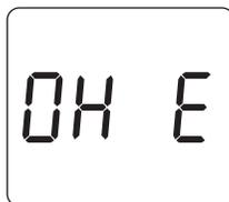
測定器内部温度が 40℃以上で動作可能温度を超えた時に表示されます。
