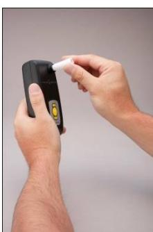
②マウスピースを準備し、センサーの右上部にある吹き込み口に挿し入ります。
