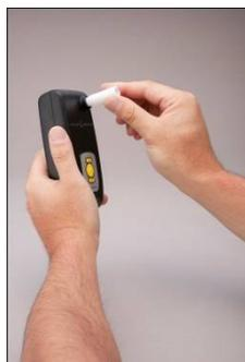
②マウスピースを準備し、センサーの右上部にある吹き込み口に挿し入みます。
