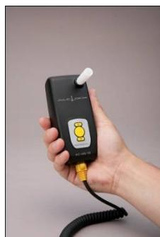
③センサーの前面にある決定ボタン（丸）を押します。インターロック全体の電源が入ります。カメラユニットが点灯し、「ウォームアップ中です」というアナウンスが流れます（Ⅱの場合、SDカードが挿入されていないと「メモリカードが検出できませんでした」というアナウンスが流れます。
