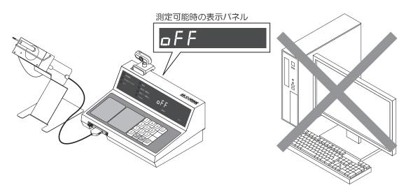
PC と通信しないモードです。測定開始キーを押すだけで、(ID 入力をしないで)測定できるようになります。 測定数値が表示パネルに表示されるだけで、測定結果はどこにも保存されません。 表示された測定数値を紙に書き残すなどお客様の運用方法に従ってご利用ください。
