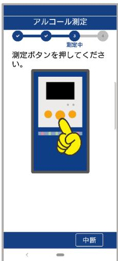
⑨ペアリングされている ALC-Mobile II の電源を入れた後、測定開始ボタンを押します。
