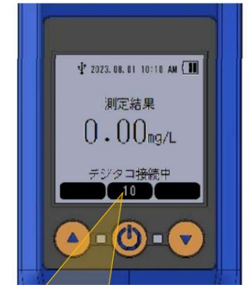
測定結果表示後 10 秒後に自動で電源 OFF します。メモリーに結果は保持されていますので、電源再投入後、メニューから確認することが可能です。
