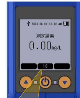
測定結果表示後 10 秒後に自動で電源 OFF します。メモリーに結果は保持されていますので、電源再投入後、メニューから確認することが可能です。
