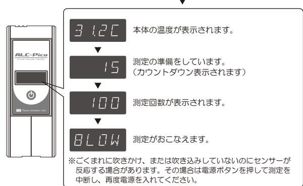
※測定を中断したい場合は、表示パネルに「BLOW」が表示されている間、もしくは測定準備のカウントダウン中に電源ボタンを押してください。測定が中断され電源が切れます。
