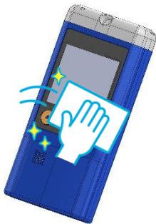
汚れが目立ってきたら、水で湿らせ硬く絞った布で拭いて、よく乾燥させた後にご使用ください。コネクタや電池の接触部には水分が付着しないようにご注意ください。
