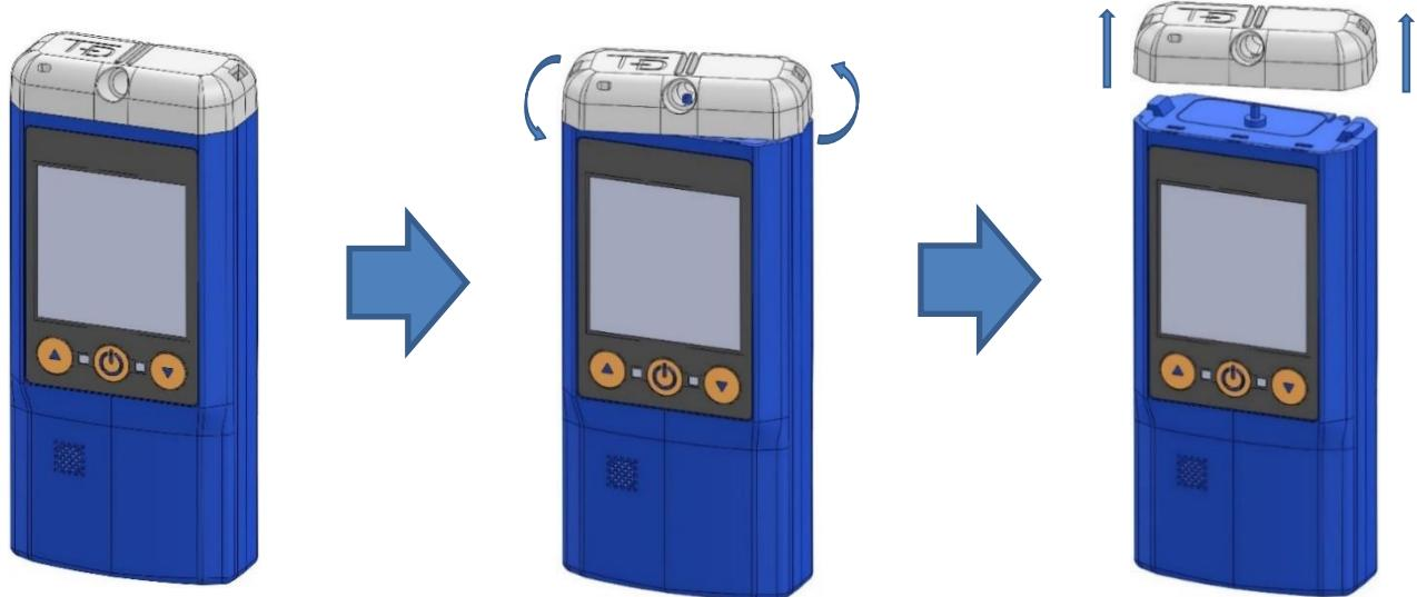
サンプリングチャンバー取り外し手順（取り付けは逆の手順で行います）。
