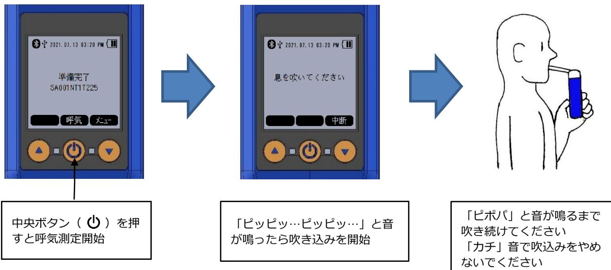
② 吹き込んだ呼気の強さが適正だと無音に切り替わります。呼気が強過ぎたり弱過ぎたりすると警告音「ピピピピピ・・・」が鳴り、限度を超えると以下のようなエラーとなります。
