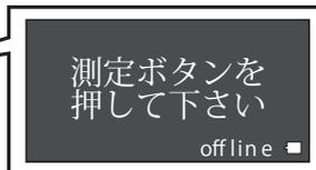
表示画面に、「測定ボタンを押して下さい」と表示されている状態で、(⊙) ボタンを画面の表示が消えるまで長押しします。
