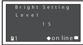
▽ ▲ ボタンを押して明るさを選びます。ボタンを押すごとに明るさが変わります。明るさは 0～15 の間で選択できます。初期設定は、15 になっています。希望の明るさになったら ○ ボタンを押します。
