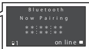
チェックランプ（緑）が点滅し、吹き込みモニターの左端の赤いLEDが点灯しペアリング状態になります。
