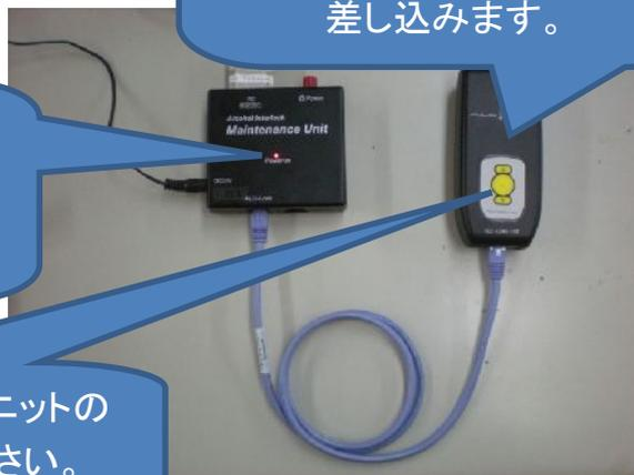
注意 ハンディユニットの電源は自動では切れません。ケーブルを繋いだまま再度接続する場合、メンテナンスツールキットの電源（赤いPowerスイッチ）を一旦切断してください。
